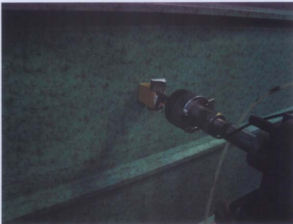
Fotografia del campione sottoposto a carico concentrato.
